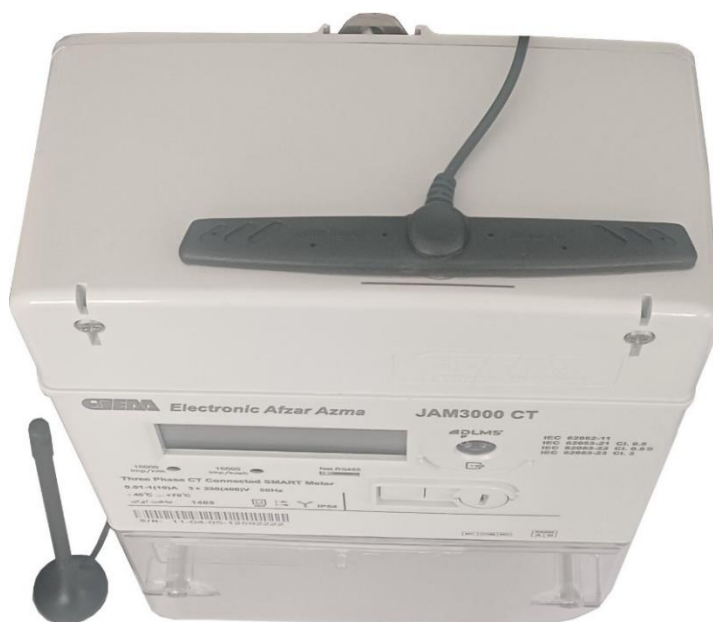
شکل ۱۱: کنتور با آنتن GSM
