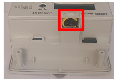
شکل ۱۴: نحوه نصب باتری خارجی
